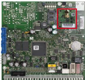
Sie haben die Übertragungseinrichtung, die mit dem aktuellen LTE-Mobilfunkmodul ausgestattet ist.
